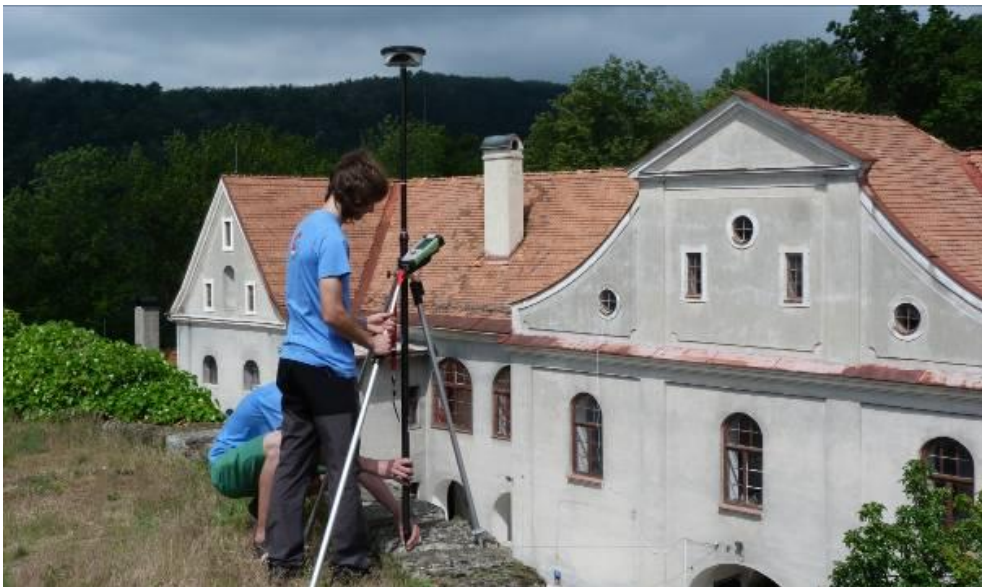
Obr. 11 Určenie bodového pol'ra pre zameranie lokality
